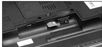
Abb. 1.3: SIM-Karte einstecken in integriertes UMTS-Modul
