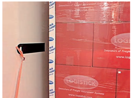
Klebbare Halterungen für Klemmbalken (links) und Kleberiegel für Einweggurte (rechts) (Quelle: Grönheit & Weigel)
