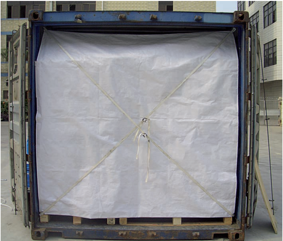
Ladungssicherungsplane als Türabschluss (Quelle: Grönheit & Weigel)
