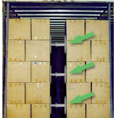
Vorgefertigter Abstandhalter einzeln und im Einsatz bei Kartonware (Quelle: Grönheit & Weigel)
