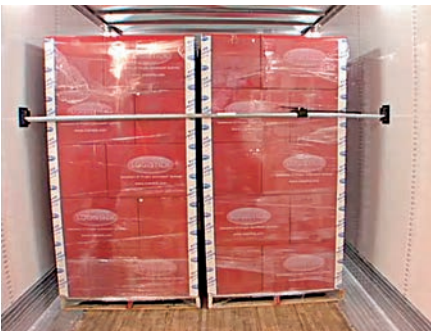
Klebbare Halterungen für Klemmbalken (links) und Kleberiegel für Einweggurte (rechts) (Quelle: Grönheit & Weigel)
