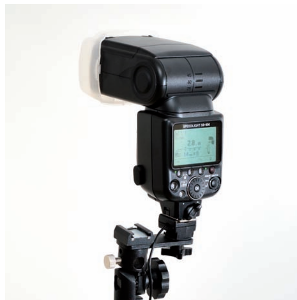
Abbildung e.1 Systemblitz von Nikon mit aufgestecktem Diffusor (auch »Joghurtbecher« genannt)
